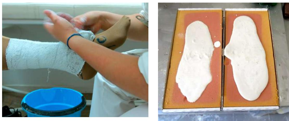
Fig. 15 Realização do molde gessado a) e moldagem das palmilhas a fabricar b)
